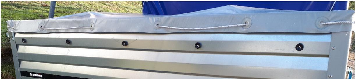
3. Seil mit den beiliegenden Würgeklemmen endlos verbinden. Das Expanderseil hat die richtige Länge für die erforderliche Spannung, um die Plane straff zu halten. Wenn Ihnen das Seil zu kurz erscheint, bitte die Schnur vom Anfang bis zum Ende straff nachziehen und ggf. die Plane von den Ecken abnehmen.
