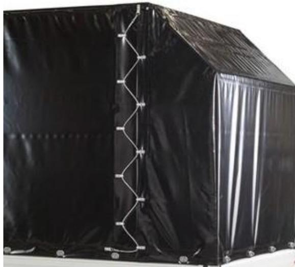
**Lichtdach** - Für das Planendach wird lichtdurchlässiges Material verwendet, so dass das Tageslicht in den Laderaum gelangen kann.
