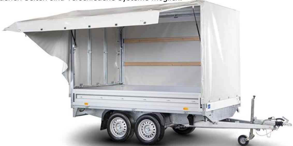
Die Klappe besteht aus einem eigenständigen Aluminiumrahmen, der in den Spriegel eingesetzt und durch Gashubfedern in die geöffnete Position gebracht wird. Ähnlich, wie Sie es von der Heckklappe Ihres Autos kennen.
