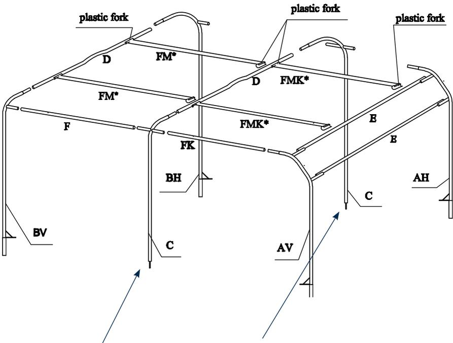
Ø6 mm Loch in die Oberkante der beiden Anhängerbordwände bohren. (teilenr. C)
